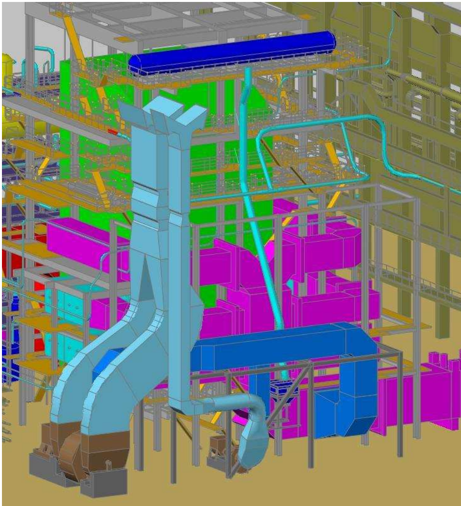
3D – модель Котла Е-500. Рабочая документация
