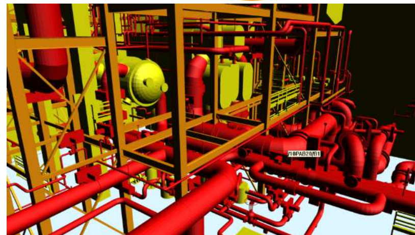
Главный корпус ПГУ-230 . Рабочая 3D – модель.
